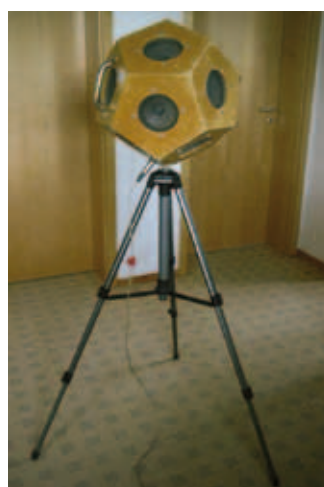
Fig. 19 – Diffusore sferico utilizzato per determinare l'isolamento acustico ai rumori aerei [7.14]
