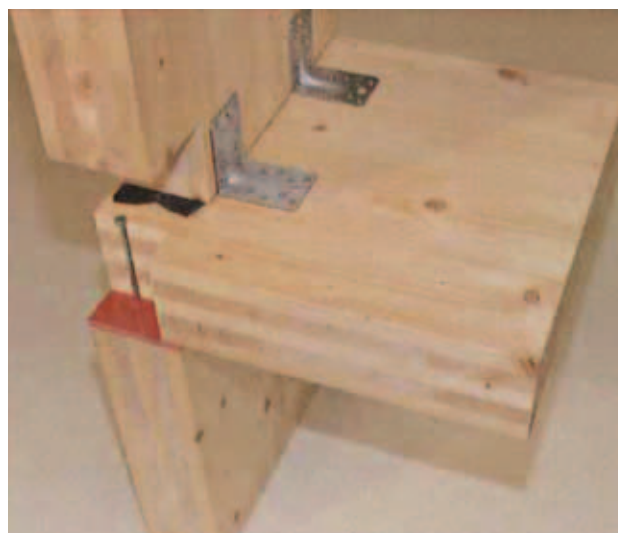
Fig. 17 – Cuscinetti Getzner (rossi, in basso) e Trelleborg (neri, in alto) come possibile correttivo della trasmissione laterale del rumore [7.7]
