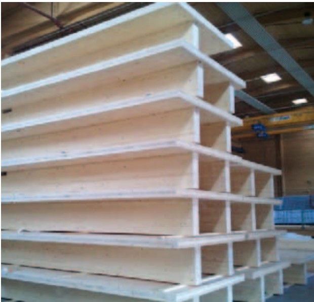
Fertige Rippenelemente, bereit für den Transport
