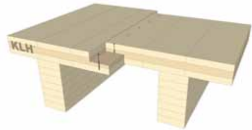
Abb. 6: Elementverbindung mit verschraubtem Stufenfals
