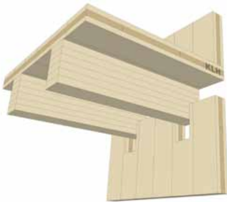
Abb. 8: Angepasster Ausschnitt für die Rippen im Wandelement
