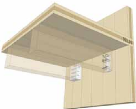
Abb. 10: Auflager des Deckenelementes auf der Wand, die Rippen werden mit geeigneten Verbindungsmitteln am Wandelement befestigt
