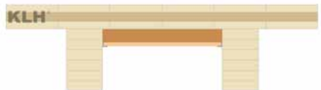
Abb. 2: Rippenzwischenraum mit Akustikelement, zurückversetzte Variante
