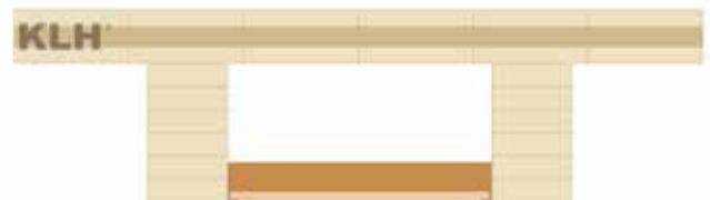
Abb. 1: Rippenzwischenraum mit Akustikelement, flächenbündige Variante
