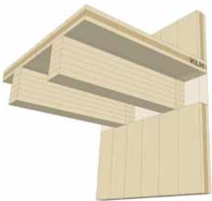
Abb. 9: Auflager der Rippen am Wandelement mit geeigneter Füllung des Zwischenraumes
