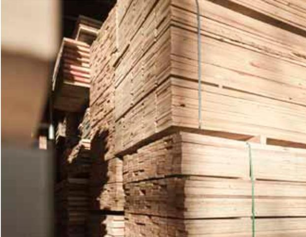
PEFC- oder FSC- zertifizierte Lamellen werden einer maschinellen Gütesortierung unterzogen und je nach Oberflächenqualität sortiert
